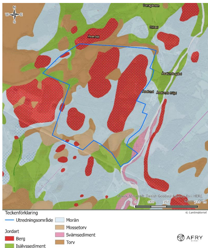
Figur 4. Karta över de jordarter som påträffas inom utredningsområdet samt i omgivningen (Källa: SGU).
