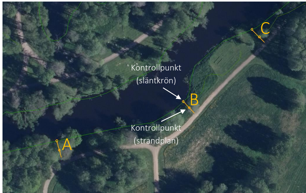
Figur 7. Bilden redovisar en principskiss över vart inmätning av kontrollpunkter ska ske i följande 3 sektioner. Notera att bilden är översiktlig och att kontrollpunkternas exakta placering blir beständigt vid den första inmätningen (nollmätningen).
