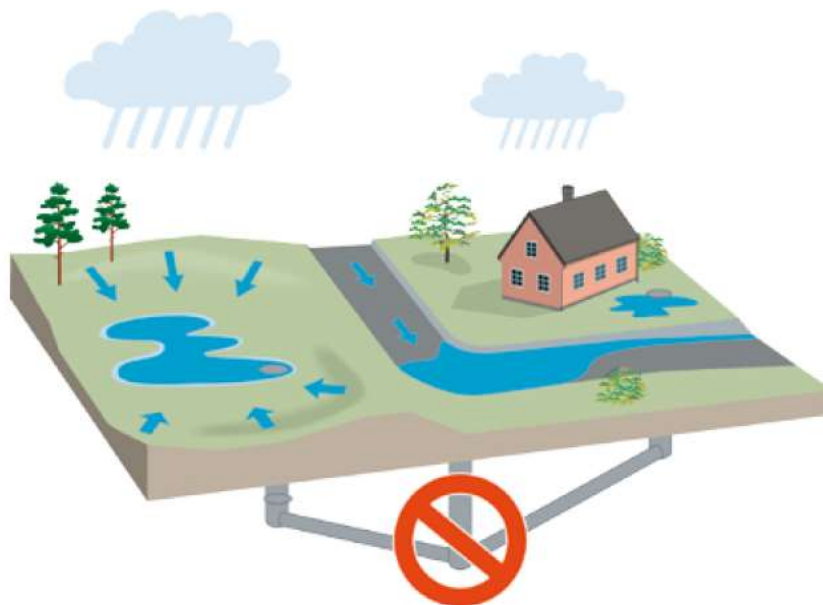
Figur 5. Princip för kartering av lågpunkter och rinnvägar. Ledningsnätets kapacitet räknas inte in. Figuren är hämtad från MSB's vägledning för skyfallskartering (MSB, 2017).
