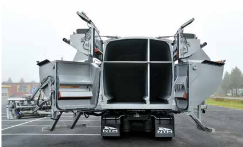
Så här ser fyrfacksbilen ut, väggar delar bilen i fyra fack.
