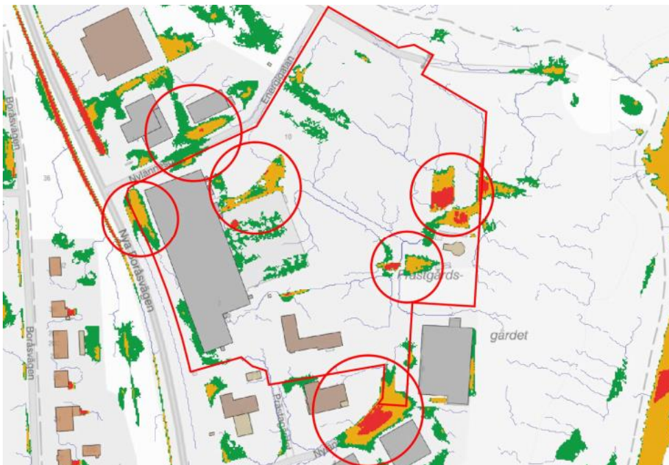
Karta som visar utdrag från Scalgo med vattenansamlingar samt rinnvägar vid ett regndjup på 60 mm. Grön färg visar vattendjup upp till 10 cm, gult 10-30 cm och rött över 30 cm. De större lågpunkterna är markerade med röda ringar. Karta hämtad från dagvattenutredning upprättad av bsv arkitekter & ingenjörer ab.
