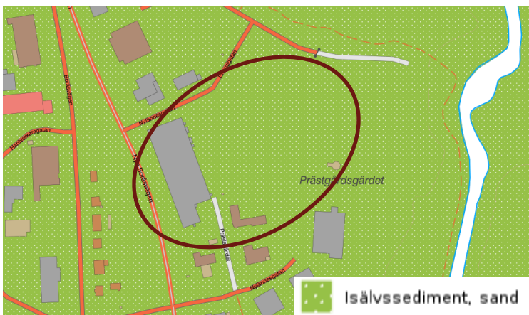
Karta hämtad från SGU som visar att jordarten inom planområdet utgörs av isälvsediment, sand.
